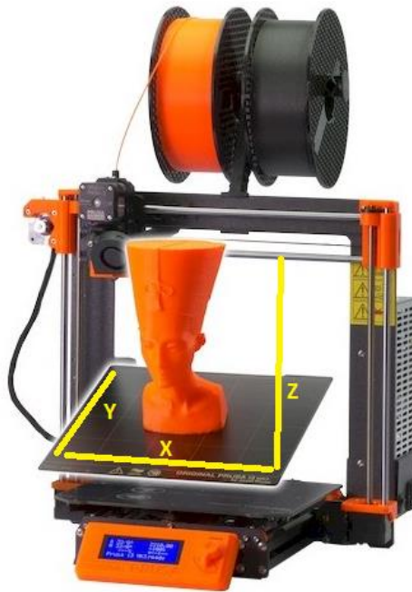
Σχήμα 41 – Περιοχή κατασκευής .Πηγή: Based on: https://shop.prusa3d.com/pl/drukarki-3d/181-drukarka-3d-original-prusa-i3-mk3s.html
